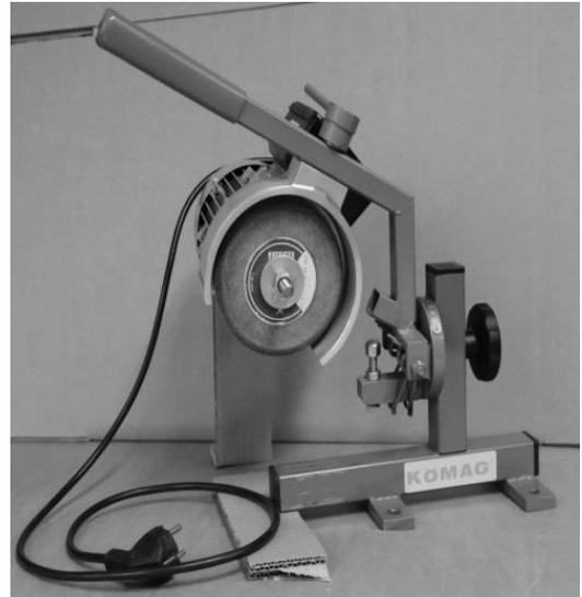
Grundgerät mit Elektromotor 220V 180W,
